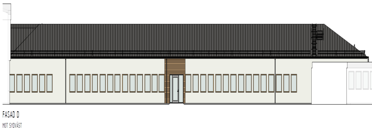
Figur 3. Ny fasad efter ombyggnad nytt tak nya fönster och fasadskiva ersätter tegel
